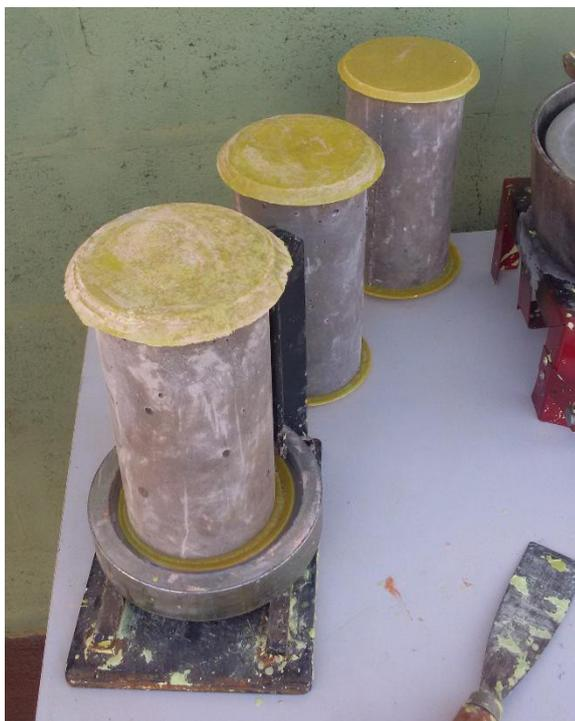
Figura 2 – Corpos de prova com capeamento
