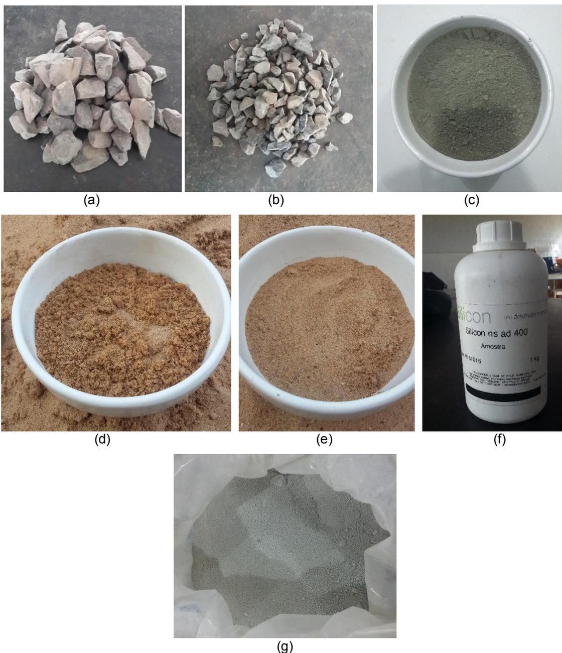
Figura 1 – Agregado graúdo diâmetro máximo de 19,00mm (a), agregado graúdo diâmetro máximo de 12,50mm (b), cimento CP-II-F40 (c), areia fina (d), areia grossa (e), aditivo superplastificante com nanosílica em suspensão coloidal (f), sílica ativa (g)
