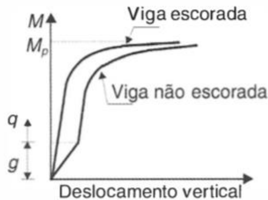
Figura 5 - Diagrama de deslocamentos verticais para a ação de cargas crescentes Fonte: Pfeil (2009).
