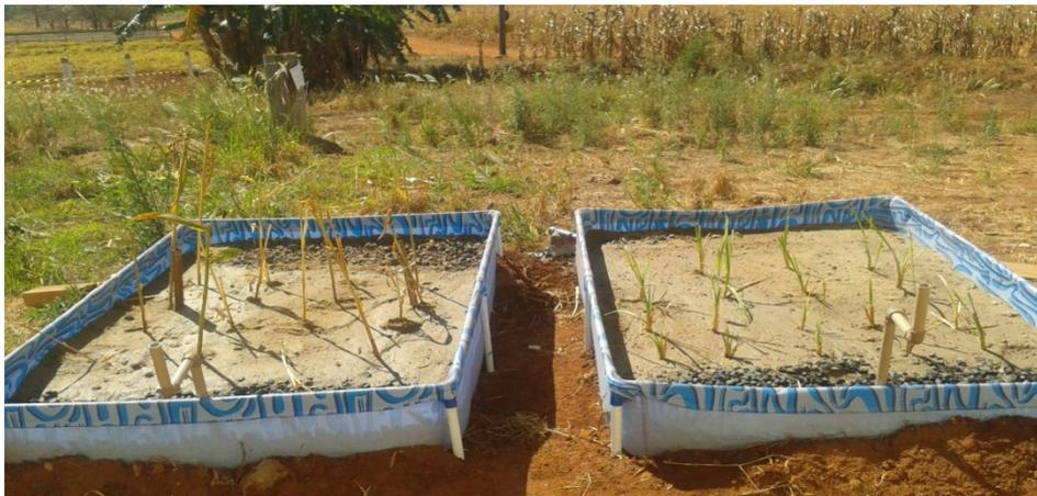
Figura 5 - Estação experimental de tratamento de efluente com as mudas transplantadas
